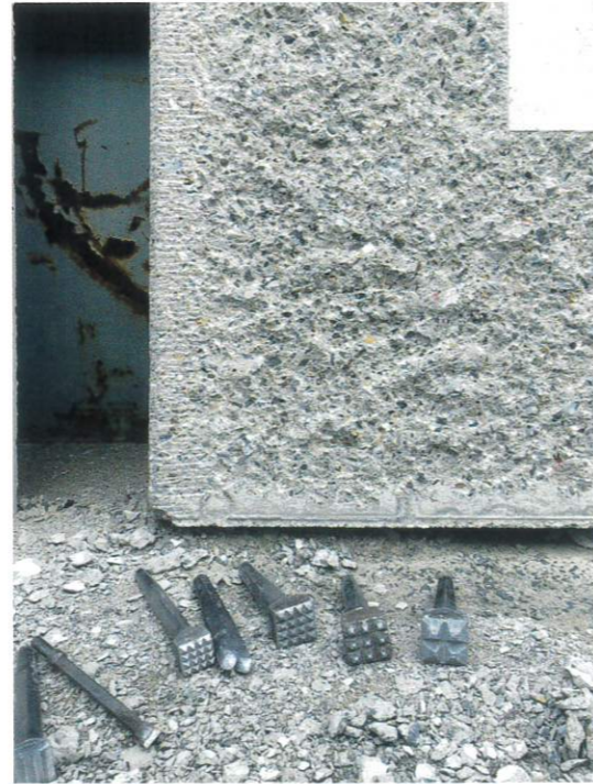
Mit unterschiedlichen Werkzeugen wurden die Texturen für die Oberflächen des Recyclingbetons vorab getestet.
